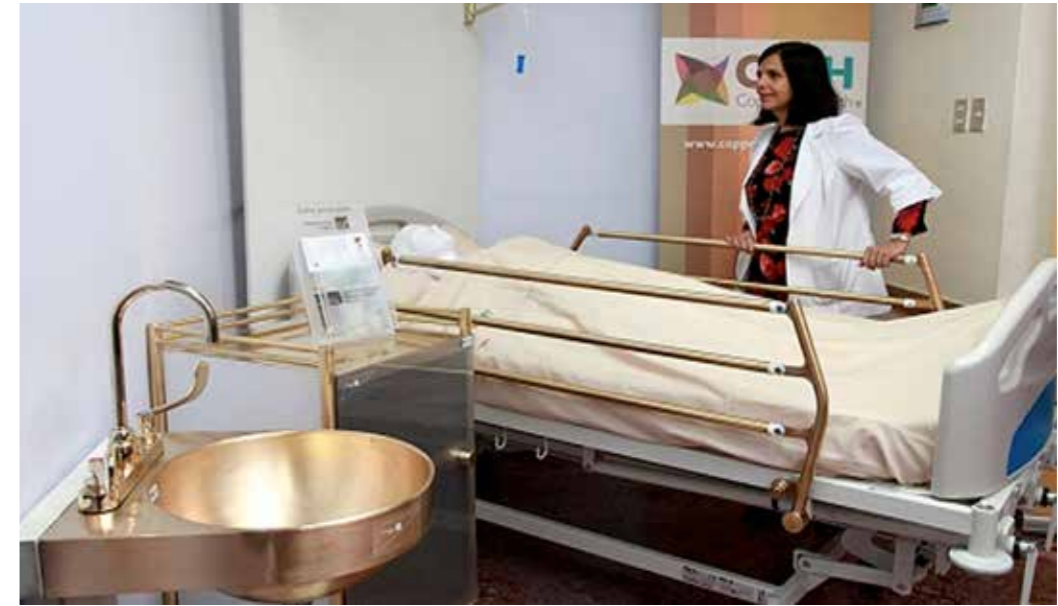
Hospital de cobre, uso del cobre antimicrobiano en barandas, lavamanos, mesa y otros mobiliarios.
